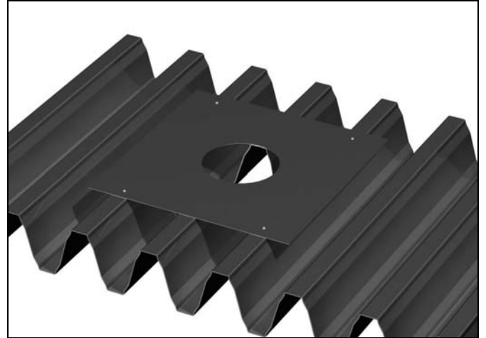
Figuur 10.34 Het aanbrengen van de verstevigingsplaat
