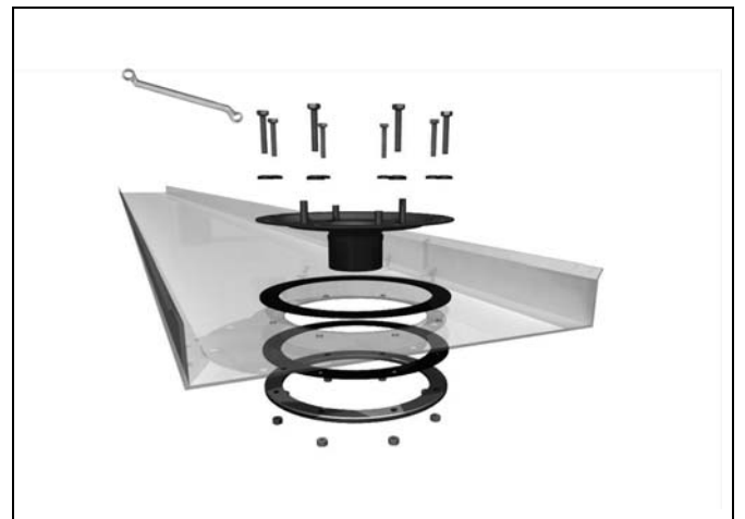
Figuur 10.16 Het monteren van de trechter
