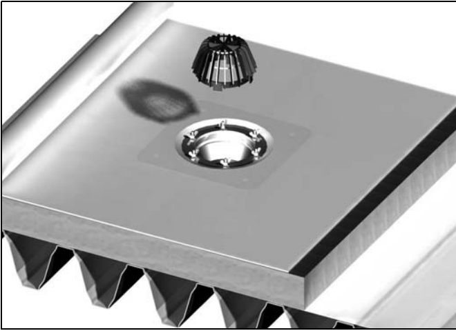
Figuur 10.31 Het aanbrengen van de bladkorf
