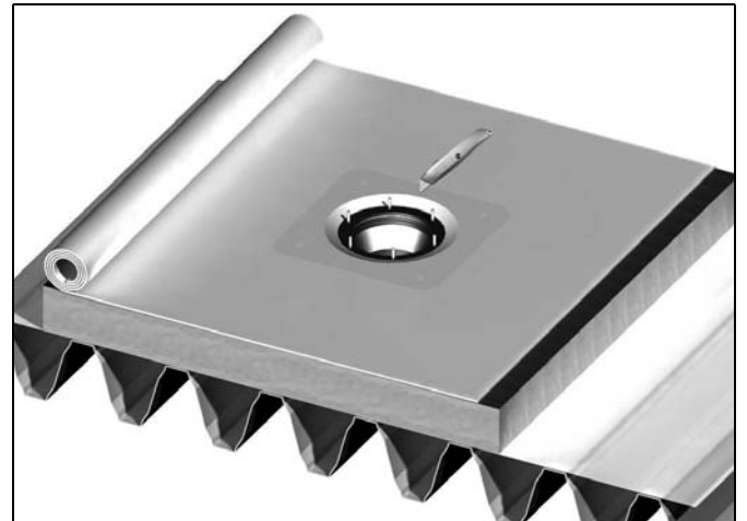
Figuur 10.29 Het aanbrengen van de toplaag
