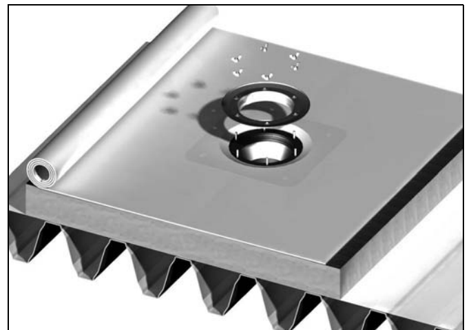
Figuur 10.30 Het aanbrengen van de klemflens
