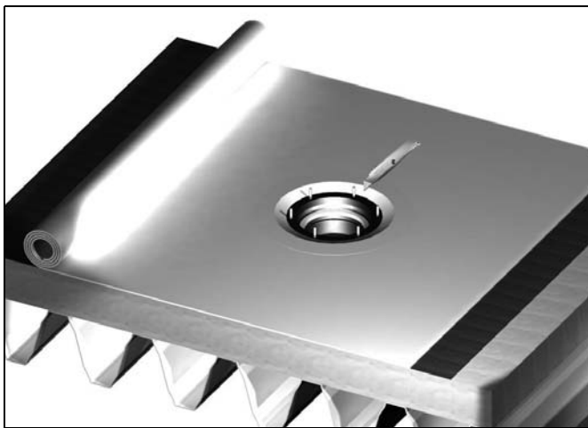
Figuur 10.28 Het verwijderen van het overtollige PVC
