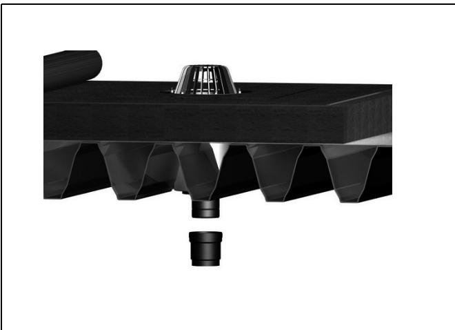
Figuur 10.32 Het aansluiten op het leidingsysteem
