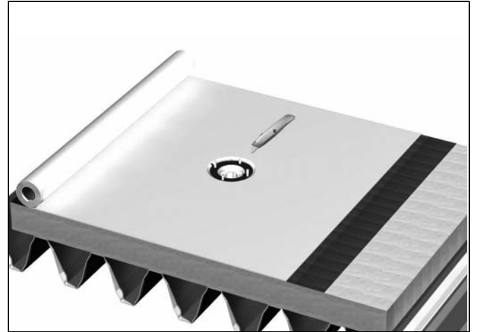
Figuur 10.51 Het verwijderen van de overtollige dakbedekking
