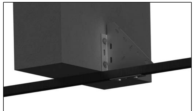
Figuur 10.64 Verbinding van rail met betonnen balk
