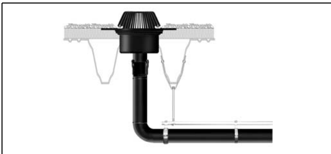
Figuur 10.77 Aansluiting aan de daktrechter
